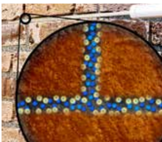
KÖSTER Crisin krema: Nema miješanja aktivnih sastojaka s vodom zbog obrnute formulacije. Naprotiv, voda se malo po malo istiskuje, aktivni sastojci ostaju u željenom položaju.
