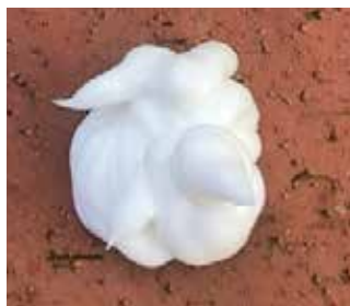
KÖSTER Crisin krema je čvrsta. Ovo je prednost pri radu s patronama i cjevastim vrećicama. Čak i kada se previše proizvoda nanese u bušotinu, višak materijala se neće slijevati na žbuku što može dovesti do tamnih mrlja. Višak materijala se može ukloniti, a bušotina naknadno ispuniti i ožbukati.
