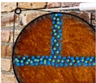
Konvencionalne kreme: Proizvod se miješa s pora vodom. U slučaju vlažnog zida aktivni sastojak je razrijeđen, smanjujući njegovu koncentraciju i raspodjela aktivnog sastojka u zidu je nekontrolirana.
